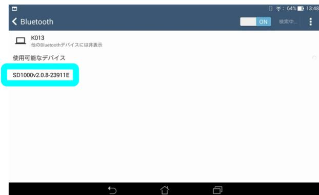
1. 接続可能な機器欄に“SD1000v..x.x.-xxxxxxが表示されている。”ことを確認し、タップします。
